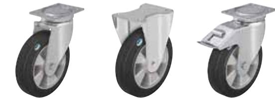
**Soporte:** Serie LU/BH - Estampado de chapa de acero gruesa, soporte giratorio con cojinete a bolas de cuatro puntos en la cabeza giratoria para una captación óptima de fuerzas verticales y horizontales, cabeza giratoria cerrada y sellada. El uso de cojinetes endurecidos junto con el procedimiento especial Blickle de remachar aumenta la robustez contra golpes y choques y resulta en una marcha suave, un desgaste mínimo y una alta durabilidad.
