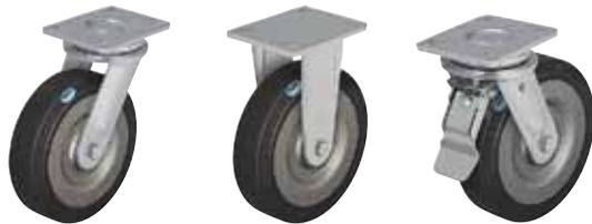
**Soporte:** Serie LO/BO - Sólida construcción de acero soldado, soporte giratorio con doble carril de bolas en cabeza giratoria, adicionalmente reforzada con **cuatro cojinetes endurecidos de forma especial**, cabeza giratoria sellada mediante construcción de laberinto, con engrasador, con vástago central muy robusto, soldado, atornillado y asegurado.
