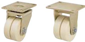
**Soporte:** Serie LSD/BSO - Construcción de acero soldado extremadamente robusta, soporte giratorio con cojinete axial ranurado de bolas según DIN 711 y cojinete de rodillos cónicos según DIN 720 en la cabeza giratoria, protegido contra polvo y agua salpicada, con engrasador, con vástago central muy robusto, soldado, atornillado y asegurado.
