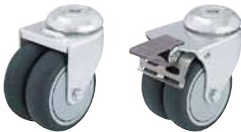
**Soporte:** Serie LMDA - Estampado de chapa de acero, con doble carril de bolas en la cabeza giratoria, protección de bolas mediante forma especial de la placa base y arandela esférica, cabeza giratoria remachada.
