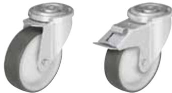
**Soporte:** Serie LKR - Estampado de chapa de acero gruesa, con doble carril de bolas en cabeza giratoria, con robusto vástago central, protección de bolas mediante forma especial de la placa base y arandela esférica. El carril de bolas está remachado dinámicamente según un procedimiento especial de Blickle. Este proceso resulta en un juego mínimo de la cabeza giratoria, una marcha suave y una alta durabilidad debido al endurecimiento en frío del carril de bolas.
