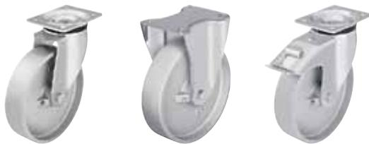
**Soporte:** Serie LK/BK/BH - Estampado de chapa de acero gruesa, soporte giratorio con doble carril de bolas en cabeza giratoria, con robusto vástago central (para ruedas Ø 125x50 - 200 mm), con cabeza giratoria sellada. El carril de bolas está remachado dinámicamente según un procedimiento especial de Blickle. Este proceso resulta en un juego mínimo de la cabeza giratoria, una marcha suave y una alta durabilidad debido al endurecimiento en frío del carril de bolas.
