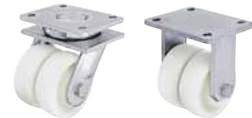
**Soporte:** Serie LOD/BOD - Sólida construcción de acero soldado, soporte giratorio con doble carril de bolas en cabeza giratoria, adicionalmente reforzada con **cuatro cojinetes endurecidos de forma especial**, cabeza giratoria sellada mediante construcción de laberinto, con engrasador, con muy robusto vástago central, soldado, atornillado y asegurado.
