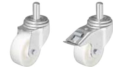
**Soporte:** Serie LHZ - Estampado de chapa de acero gruesa, con placa y brazos reforzados, con espiga de acero soldado introducible y muy robusta, atornillado y asegurado, con doble carril de bolas en cabeza giratoria, adicionalmente reforzada con **cuatro cojinetes endurecidos de forma especial**, por lo tanto especialmente insensible a golpes y choques.
