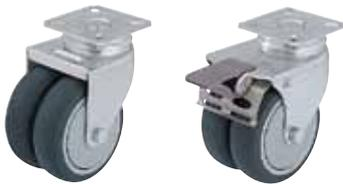
**Soporte:** Serie LDA - Estampado de chapa de acero, con doble carril de bolas en la cabeza giratoria, protección de bolas mediante forma especial de la placa base y arandela esférica, cabeza giratoria remachada.
