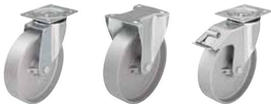
**Soporte:** Serie L/B - Estampado de chapa de acero, soporte giratorio con doble carril de bolas en cabeza giratoria, con robusto vástago central (para ruedas con Ø 150-200 mm), con cabeza giratoria sellada. El carril de bolas está remachado dinámicamente según un procedimiento especial de Blickle. Este proceso resulta en un juego mínimo de la cabeza giratoria, una marcha suave y una alta durabilidad debido al endurecimiento en frío del carril de bolas.
