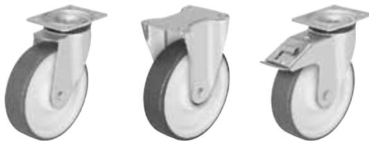
**Soporte:** Serie LK/BK/BH - Estampado de chapa de acero gruesa, soporte giratorio con doble carril de bolas en cabeza giratoria, con robusto vástago central (para ruedas Ø 150-200 mm), con cabeza giratoria sellada. El carril de bolas está remachado dinámicamente según un procedimiento especial de Blickle. Este proceso resulta en un juego mínimo de la cabeza giratoria, una marcha suave y una alta durabilidad debido al endurecimiento en frío del carril de bolas.
