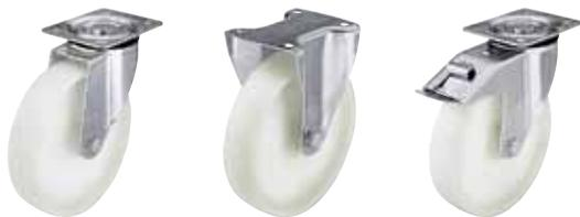
**Soporte:** Serie L/B - Estampado de chapa de acero, soporte giratorio con doble carril de bolas en cabeza giratoria, con robusto vástago central (para ruedas con Ø 150-200 mm), con cabeza giratoria sellada. El carril de bolas está remachado dinámicamente según un procedimiento especial de Blickle. Este proceso resulta en un juego mínimo de la cabeza giratoria, una marcha suave y una alta durabilidad debido al endurecimiento en frío del carril de bolas.
