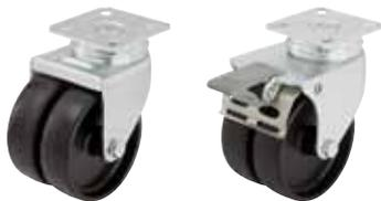
**Soporte:** Serie LDA - Estampado de chapa de acero, con doble carril de bolas en la cabeza giratoria, protección de bolas mediante forma especial de la placa base y arandela esférica, cabeza giratoria remachada.
