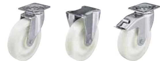
**Soporte:** Serie LH/BH - Estampado de chapa de acero gruesa, soporte giratorio con placa y brazos reforzados, con muy robusto vástago central atornillado y asegurado, con doble carril de bolas en cabeza giratoria, adicionalmente reforzada con **cuatro cojinetes endurecidos de forma especial**, por lo tanto especialmente insensible a golpes y choques.
