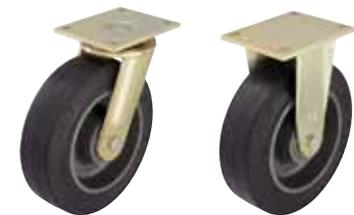
**Soporte:** Serie LS/BS - Construcción de acero soldado extremadamente robusta, soporte giratorio con cojinete axial ranurado de bolas según DIN 711 y cojinete de rodillos cónicos según DIN 720 en la cabeza giratoria, protegido contra polvo y agua salpicada, con engrasador, con vástago central muy robusto, soldado, atornillado y asegurado. Eje de rueda atornillado. Zincado, pasivado color amarillo, libre de Cr6. Resumen de soportes: Página 68 Croquis de las patinas atornillables: Página 78
