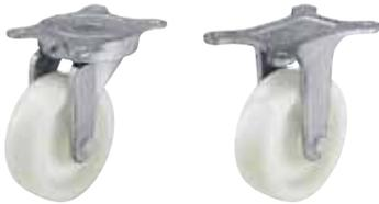
**Soporte:** Serie LT/BT - Fundición maleable de alta calidad, soporte giratorio con doble carril de bolas en la cabeza giratoria (Ø de rueda 75 mm: Carril de bolas simple), protección de bolas mediante forma especial de la platina atornillable y soporte giratorio, con engrasador.
