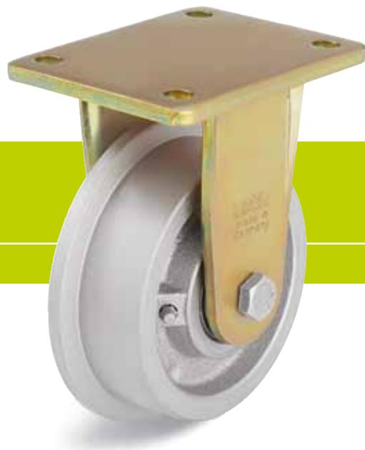
**Soporte:** Serie BS - Construcción de acero soldado extremadamente robusta, con brazos laterales especialmente reforzados para aumentar la resistencia a fuerzas axiales. Eje de rueda atornillado. Zincado, pasivado color amarillo, libre de Cr6. Resumen de soportes: Página 68 Croquis de las patinas atornillables: Página 77 y 78
