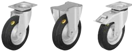
**Soporte:** Serie LK/BK/BH - Estampado de chapa de acero gruesa, soporte giratorio con doble carril de bolas en cabeza giratoria, con robusto vástago central (para ruedas Ø 160-200 mm), con cabeza giratoria sellada. El carril de bolas está remachado dinámicamente según un procedimiento especial de Blickle. Este proceso resulta en un juego mínimo de la cabeza giratoria, una marcha suave y una alta durabilidad debido al endurecimiento en frío del carril de bolas.
