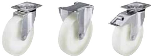
**Soporte:** Serie L/B - Estampado de chapa de acero, soporte giratorio con doble carril de bolas en cabeza giratoria, con robusto vástago central (para ruedas Ø 150 mm), con cabeza giratoria sellada. El carril de bolas está remachado dinámicamente según un procedimiento especial de Blickle. Este proceso resulta en un juego mínimo de la cabeza giratoria, una marcha suave y una alta durabilidad debido al endurecimiento en frío del carril de bolas.
