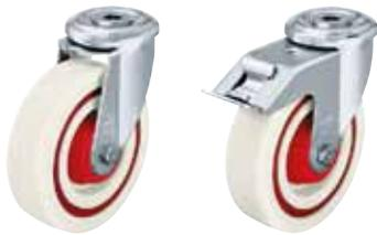
**Soporte:** Serie LER - Estampado de chapa de acero, con doble carril de bolas en cabeza giratoria, robusto vástago central, protección de bolas mediante forma especial de la placa base y arandela esférica. El carril de bolas está remachado dinámicamente según un procedimiento especial de Blickle. Este proceso resulta en un juego mínimo de la cabeza giratoria, una marcha suave y una alta durabilidad debido al endurecimiento en frío del carril de bolas.
