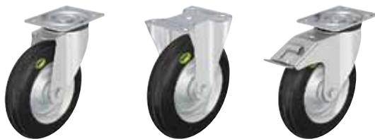
**Soporte:** Serie L/BH - Estampado de chapa de acero, soporte giratorio con doble carril de bolas en cabeza giratoria, con robusto vástago central (para ruedas Ø 160-260 mm), con cabeza giratoria sellada (excepción: Dimensión de platina 175x175 mm). El carril de bolas está remachado dinámicamente según un procedimiento especial de Blickle. Este proceso resulta en un juego mínimo de la cabeza giratoria, una marcha suave y una alta durabilidad debido al endurecimiento en frío del carril de bolas.
