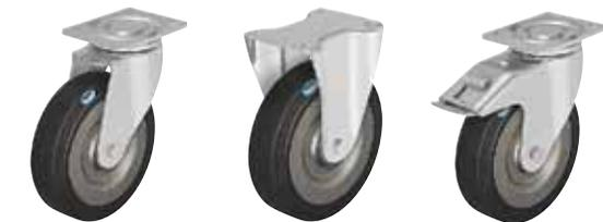
**Soporte:** Serie LH/BH - Estampado de chapa de acero gruesa, soporte giratorio con placa y brazos reforzados, con muy robusto vástago central atornillado y asegurado, con doble carril de bolas en cabeza giratoria, adicionalmente reforzada con **cuatro cojinetes endurecidos de forma especial**, por lo tanto especialmente insensible a golpes y choques.
