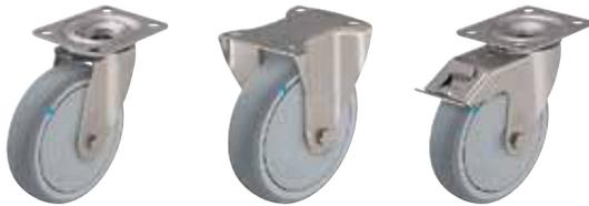
**Soporte:** Serie LEX/BX - Estampado de acero cromo-níquel inoxidable de alta calidad (n° de material 1.4301/AISI 304), soporte giratorio con doble carril de bolas en cabeza giratoria, con cabeza giratoria sellada. El carril de bolas está remachado dinámicamente según un procedimiento especial de Blickle. Este proceso resulta en un juego mínimo de la cabeza giratoria, una marcha suave y una alta durabilidad debido al endurecimiento en frío del carril de eje, son inoxidables.
