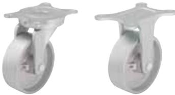
**Soporte:** Serie LT/BT - Fundición maleable de alta calidad, soporte giratorio con doble carril de bolas en la cabeza giratoria (Ø de rueda 65-80 mm: Carril de bolas simple), protección de bolas mediante forma especial de la platina atornillable y soporte giratorio, con engrasador.
