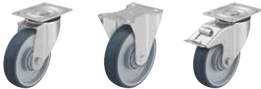
**Soporte:** Serie L/B - Estampado de chapa de acero, soporte giratorio con doble carril de bolas en cabeza giratoria, con robusto vástago central (para ruedas Ø 160-200 mm), con cabeza giratoria sellada. El carril de bolas está remachado dinámicamente según un procedimiento especial de Blickle. Este proceso resulta en un juego mínimo de la cabeza giratoria, una marcha suave y una alta durabilidad debido al endurecimiento en frío del carril de bolas.
