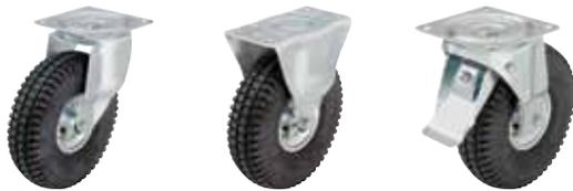
**Soporte:** Serie L/B - Estampado de chapa de acero, soporte giratorio con doble carril de bolas en cabeza giratoria, con robusto vástago central, con cabeza giratoria sellada (excepción: Dimensión de platina 175x175 mm). El carril de bolas está remachado dinámicamente según un procedimiento especial de Blickle. Este proceso resulta en un juego mínimo de la cabeza giratoria, una marcha suave y una alta durabilidad debido al endurecimiento en frío del carril de bolas.
