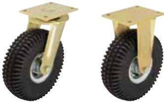
**Soporte:** Serie LS/BS - Construcción de acero soldado extremadamente robusta, soporte giratorio con cojinete axial ranurado de bolas según DIN 711 y cojinete de rodillos cónicos según DIN 720 en la cabeza giratoria, protegido contra polvo y agua salpicada, con engrasador, con vástago central muy robusto, soldado, atornillado y asegurado. Eje de rueda atornillado. Zincado, pasivado color amarillo, libre de Cr6. Resumen de soportes: Página 68 Croquis de las patinas atornillables: Página 78
