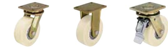
**Soporte:** Serie LS/BS - Construcción de acero soldado extremadamente robusta, soporte giratorio con cojinete axial ranurado de bolas según DIN 711 y cojinete de rodillos cónicos según DIN 720 en la cabeza giratoria, protegido contra polvo y agua salpicada, con engrasador, con vástago central muy robusto, soldado, atornillado y asegurado.
