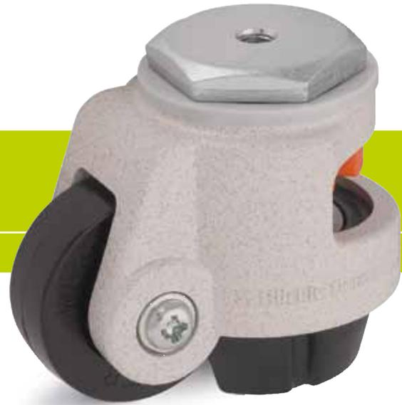
**Soporte:** Serie HRIG - De aluminio fundido a presión, con cojinete a bolas sellado en cabeza giratoria, con platina de acero hexagonal, con rosca interior en el agujero pasante. Revestimiento de polvo, color marfil. Pata de fijación de goma dura, color negro. Regulación de altura mediante llave de boca o rueda ajustable integrada. Eje de rueda atornillado. Componentes de acero zincados, pasivados color azul, libres de Cr6. Resumen de soportes: Página 73
